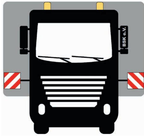
**Fall 2:** Breite der Fahrzeugkombination beträgt mehr als 2,75 m, Kenntlichmachung z. B. mittels Folienbelag an der Fahrzeugkombination und mittels Park-Warntafeln an der überbreiten Ladung, Höhe der Anbringung der Folie/der Tafeln: maximal 1,50 m (Unterkante der retroreflektierenden Fläche) über Fahrbahn
